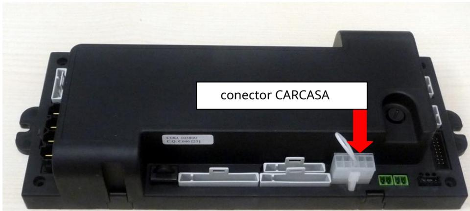
Vuelva a conectar la nueva placa de circuito (**tenga cuidado de no invertir las sondas de temperatura**)
